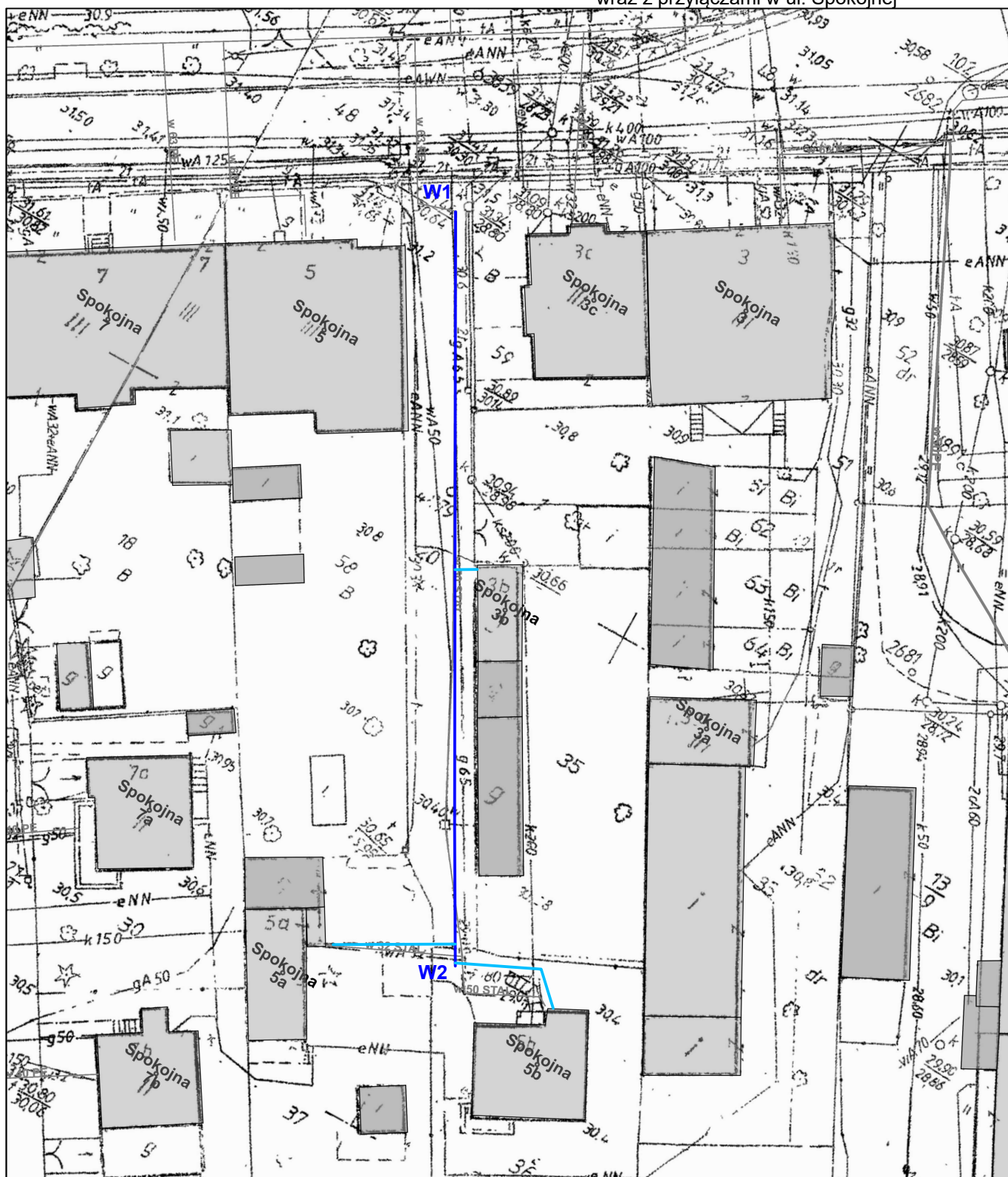
Załącznik 1-Rys. 1 Wymiana sieci wodociągowej wraz z przyłączami w ul. Spokojnej
