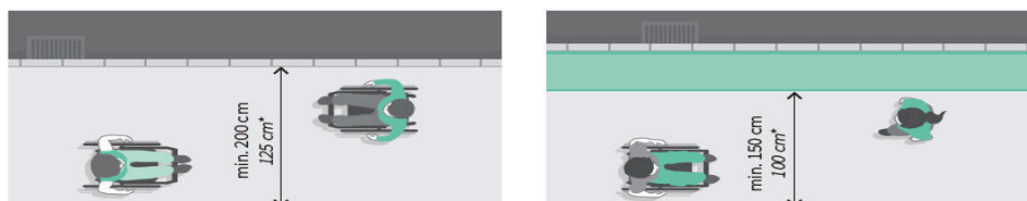
Szerokość chodnika w zależności od położenia przestrzeni pieszej względem jezdni. Po lewej – chodnik przy jezdni, po prawej – chodnik oddzielony od jezdni. * Szerokość dopuszczalna w przypadku przebudowy.
