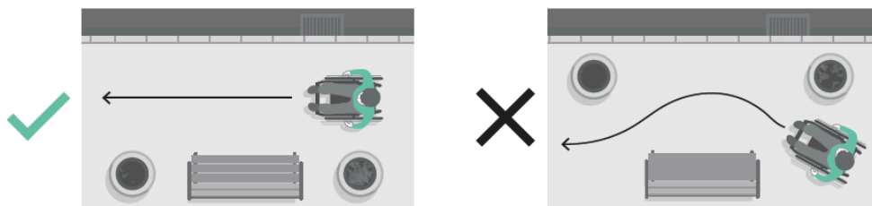
Prawidłowe i nieprawidłowe usytuowanie małej architektury na ciągach pieszych.
