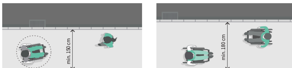
Po lewej – manewrowanie wózkiem oraz mijanie się osoby na wózku i osoby sprawnej przy szerokości chodnika 150 cm. Po prawej – mijanie się dwóch osób na wózkach przy szerokości chodnika 180 cm.
