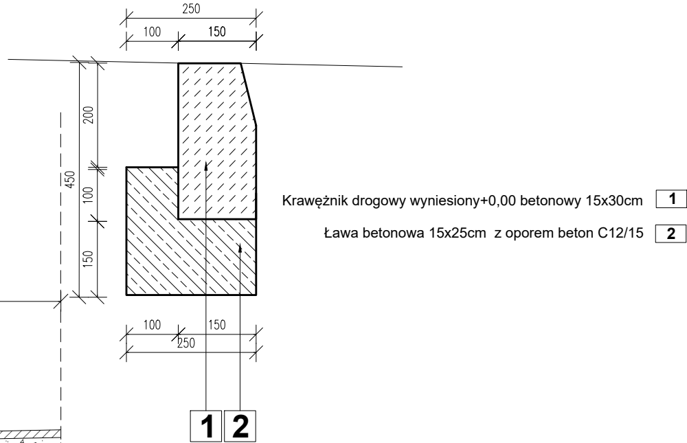
DETAL KONSTRUKCYJNY "C" SKALA 1:10
