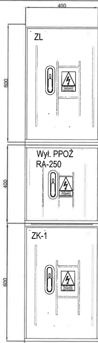
Rozdzielnica ZK+WG+TL stan istniej.
